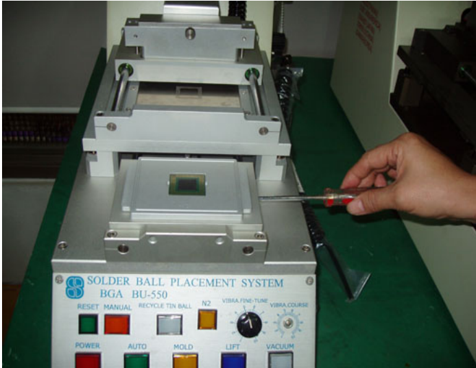
右側螺絲 X 軸調整
