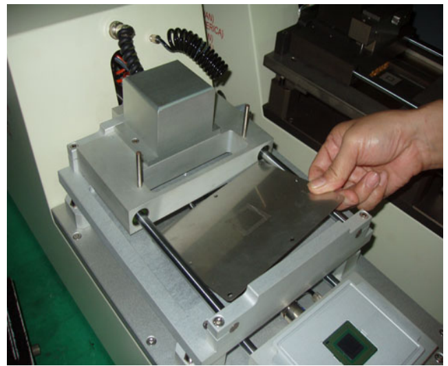
取下鋼片更換欲上線規格
