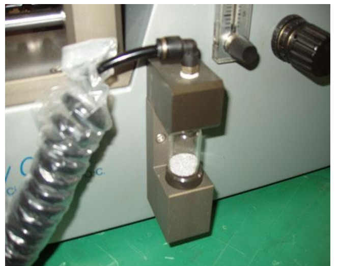
软管吸取后导入储球瓶
